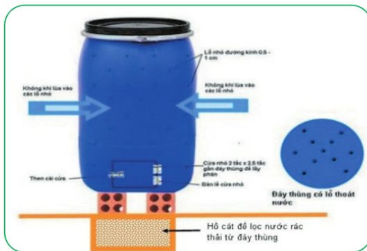
Hình 5.1. Thùng xử lý chất thải thực phẩm thành phân hữu cơ vi sinh
